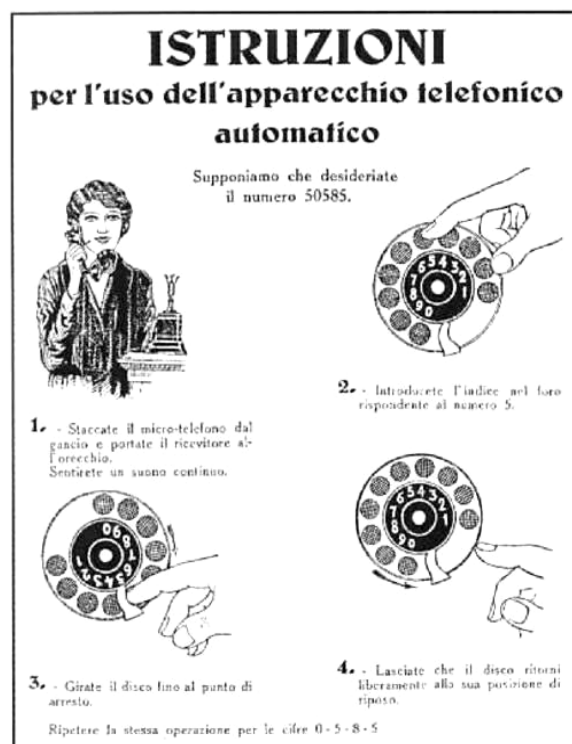
Guida illustrata all'uso del selettore decadico per la composizione dei numeri telefonici
