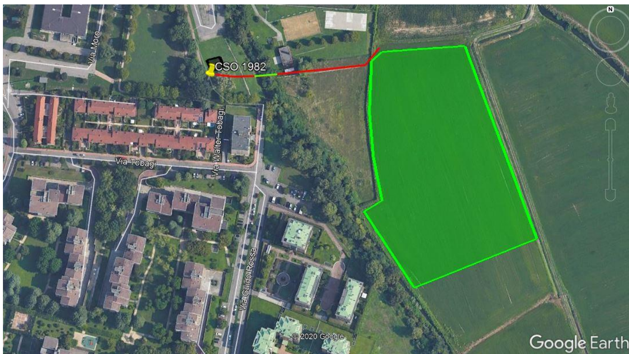
Figura 62. Rappresentazione grafica degli ingombri (verde chiaro) ed elementi progettuali (trattamenti primari, in nero; fognatura in pressione, in rosso; tratto in pressione sotto alveo, in verde chiaro) per l'Alternativa 2.3 (VF + FWS – Approccio italiano – in area parco). Elaborazione Google Earth Pro.
