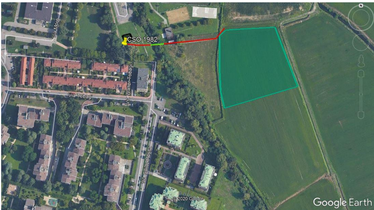
Figura 60. Rappresentazione grafica degli ingombri (verde) ed elementi progettuali (trattamenti primari, in nero; fognatura in pressione, in rosso; tratto in pressione sotto alveo, in verde chiaro) per l'Alternativa 2.2 (VF + FWS – Approccio italiano). Elaborazione Google Earth Pro.
